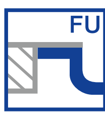
Instalación enrasada para bajo encimera: instalación casi sin problemas desde abajo para un aspecto moderno y elegante.
